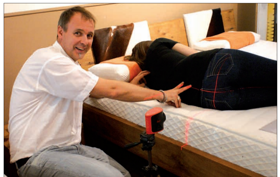
Mit einem Laser wird das Einsinken der Schulter sowie der Becken- und Kniestand in der Seitenlage überprüft.
