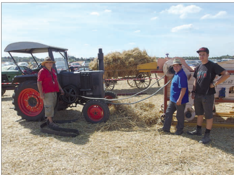
In sengender Hitze verbinden Hardy Ceglarek (links) und seine Helfer einen historischen Schlepper mit einer Dreschmaschine mittels eines ebenso historischen ledernen Transmissionsriemen.
