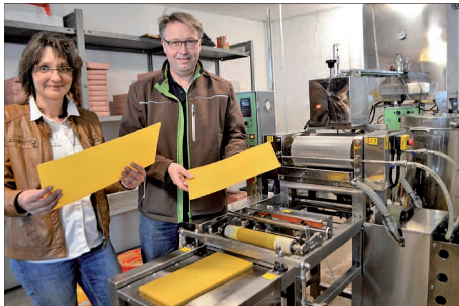
Sabine und Stefan Lindner bereiten die Mittelwand-Gießanlage vor. An ihr wollen sie beim Immentag zeigen, wie Mittelwände für das Bienenvolk oder zum Kerzendrehen produziert werden. Fotos: sam
